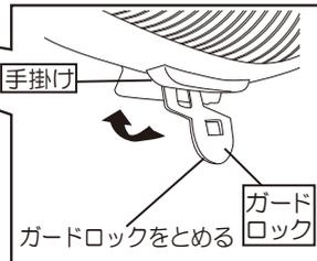
4 ガードロックが下図の位置になるように固定してください。「パチン」と音がするまで確実に強く押し込んでください。
