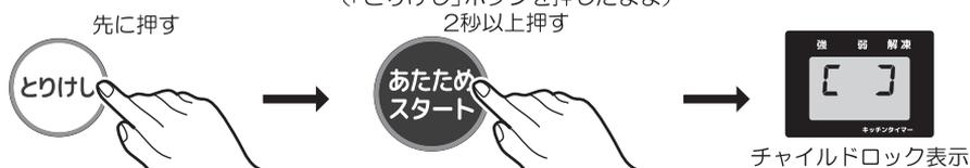
※チャイルドロックを設定している間、電源プラグを抜き差ししても、設定は解除されません。
