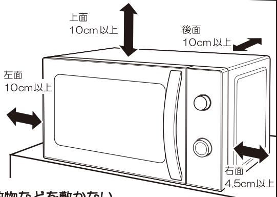
この製品は、「消防法 設置基準」に基づく試験基準に適合しています。壁の材質などによって、排気口付近の壁が汚れたり、結露することがあります。壁の汚れや結露が気になる場合は、上記の表以上の距離を確保し、壁面にアルミホイルなどを貼ることを推奨します。ただし、製品には貼らないでください。
