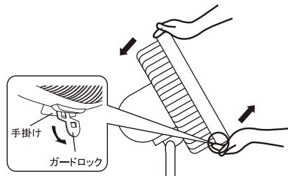
図のようにガードロックを外し、前ガードを上から押さえ、手掛けを手前に強く引きます。
