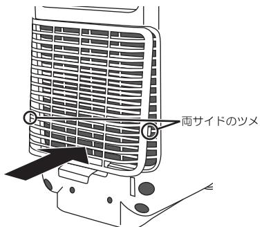
② 両サイドのツメを中に入れながらフィルターカバーが「カチッ」と音がしてロックされるまで確実に取り付けてください。
