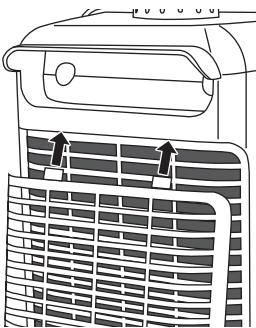
① 空気吸入口上部の2つの穴にフィルターカバーの凸部(2ヶ所)を挿します。
