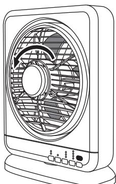
飾りリングを反時計回りに回し外します。
