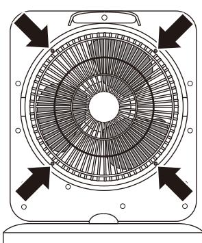
後面の後ガードをとめている4箇所のネジを取り外します。
