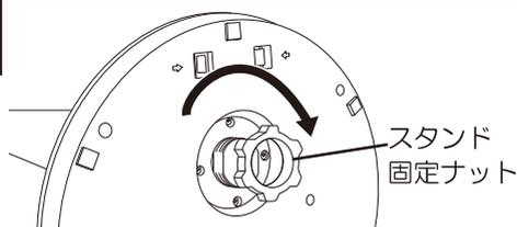
②で取り外した「スタンド固定ナット」を時計回りに回してに締め付けてください。
