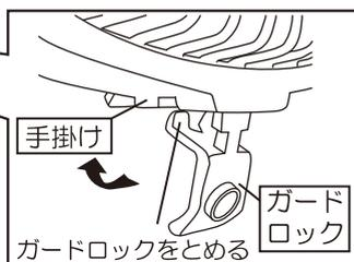
4 ガードロックが下図の位置になるように固定してください。「パチン」と音がするまで確実に強く押し込んでください。
