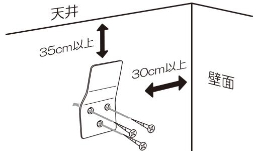
※取り付ける壁の材質により下記の通り取り付けてください。
