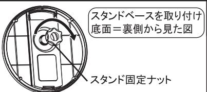
②で取り外した固定ナットを矢印の方向(時計まわり)に締め付けてください。
