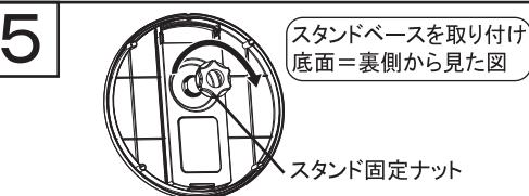
②で取り外した固定ナットを矢印の方向(時計まわり)に締め付けてください。
