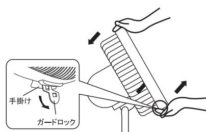
図のようにガードロックを外し、前ガードを上から押さえ、手掛けを手前に強く引きます。
