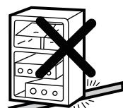
重い物をのせたり、挟み込んだり、加工したりすると、電源コードが破損し、火災・感電の原因となります。
