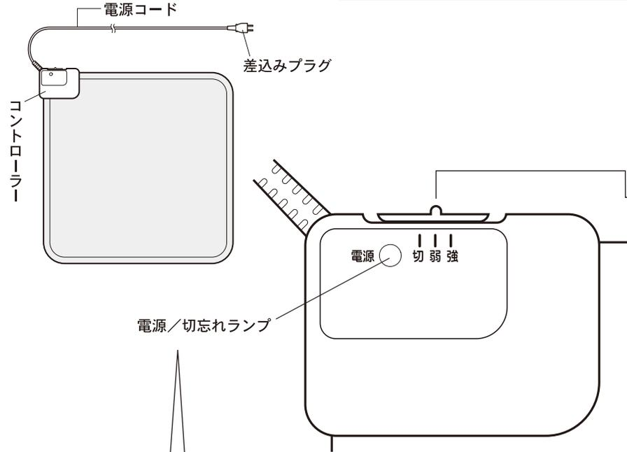
電源を入れると自動的に『切忘れタイマー』がスタートします。6時間経過すると、タイマーが働いて通電が止まり、『電源/切忘れランプ』が点滅してお知らせします。通電が止まった後も続けてご使用になる時は、一度電源を切ってから再度電源を入れ直してください。さらに6時間ご使用いただけます。
