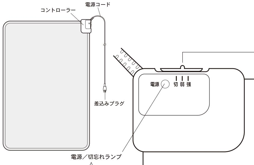
電源を入れると自動的に『切忘れタイマー』がスタートします。6時間経過すると、タイマーが働いて通電が止まり、『電源/切忘れランプ』が点滅してお知らせします。通電が止まった後も続けてご使用になる時は、一度電源を切ってから再度電源を入れ直してください。さらに6時間ご使用いただけます。
