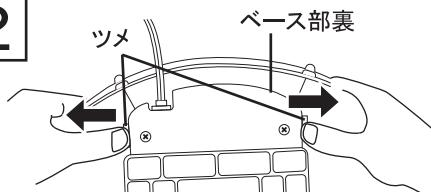
ツメを図のように両手の指で同時に外側へ広げながら、ベース部を手前に引くとベース部が外れます。
