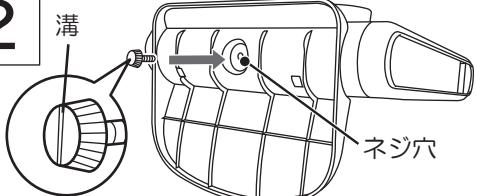
底面から付属の化粧ネジをネジ穴に入れ固定します。
