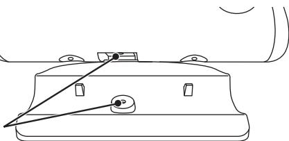
本体のネジ穴をベースのネジ穴に合わせます。
