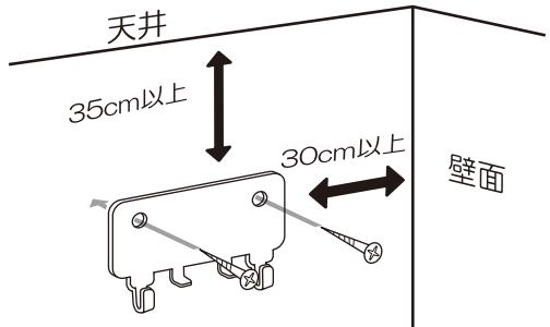
※取り付ける壁の材質により以下の通り取り付けてください。
