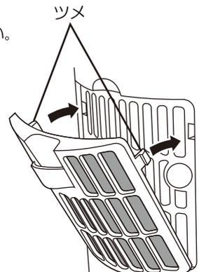
② 枠上部の穴に、フィルターカバーの「ツメ」を差し込みます。
