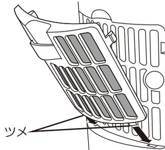
① フィルターを取り付け、枠下部の穴にフィルターカバーの「ツメ」を差し込みます。
