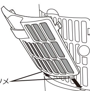
① フィルターを取り付け、枠下部の穴にフィルターカバーの「ツメ」を差し込みます。
