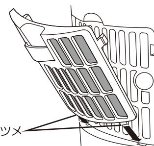
① フィルターを取り付け、枠下部の穴にフィルターカバーの「ツメ」を差し込みます。
