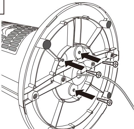
ネジ(×3)をベースに差し込み、付属のドライバーを使用して本体とベースをしっかりと固定してください。
