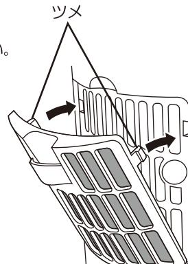
② 枠上部の穴に、フィルターかバーの「ツメ」を差し込みます。
