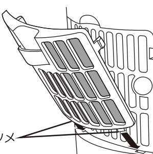
① フィルターを取り付け、枠下部の穴にフィルターかバーの「ツメ」を差し込みます。
