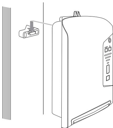
●上部壁掛けに木ネジ（短1本）を入れ図2の壁掛けフック穴にしっかり固定します。【図4】
