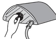
■「弱」目盛でご使用になりますと、温度調節器が働いて通電しないことがあります。その時は温度調節つまみを「中」の方向へ回しますと通電して暖かくなります。
