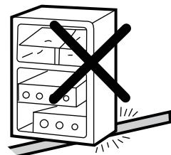
重い物をのせたり、挟み込んだり、加工したりすると、電源コードが破損し、火災感電の原因となります。
