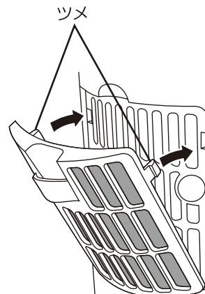
② 枠上部の穴に、フィルターカバーの「ツメ」を差し込みます。
