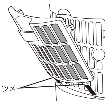
① フィルターを取りつけ、枠下部の穴にフィルターカバーの「ツメ」を差し込みます。
