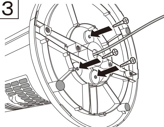
ネジ（×3）をベースに差し込み、付属のプラスドライバーを使用して本体とベースをしっかりと固定してください。
