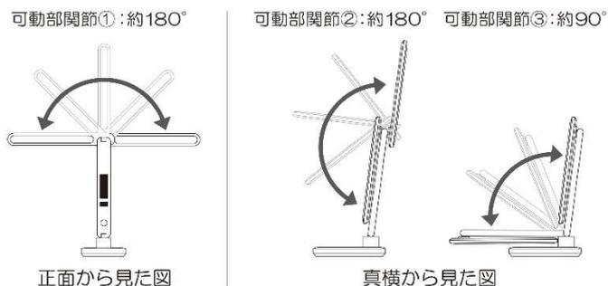
上下左右 約 180° 可動(可動部関節①②)。折りたためてスッキリ収納できる(可動部関節③)
